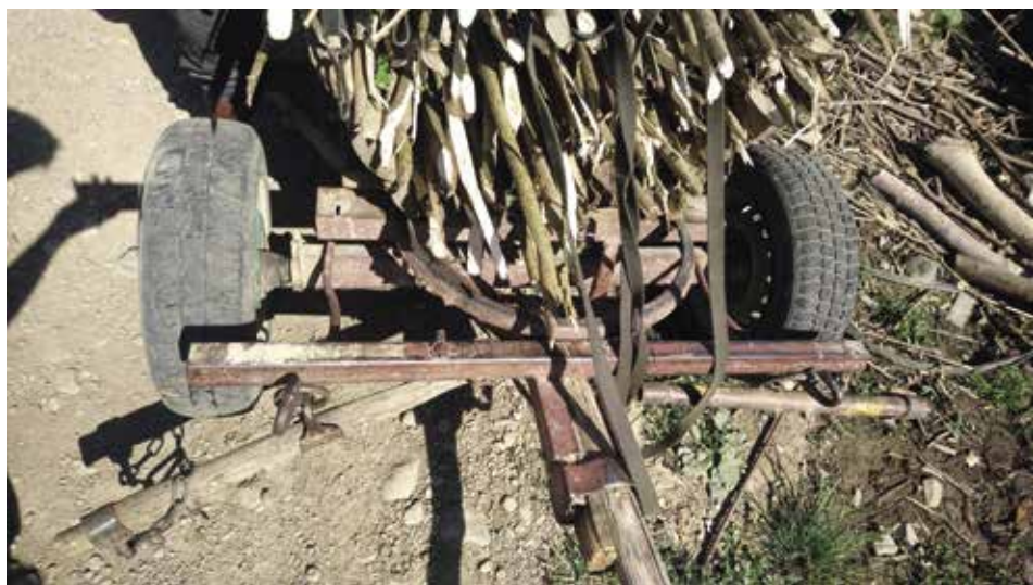
Foto č. 6. Přední část naloženého povozu s rozporkami pro dva koně. Za pozornost stojí odlišný materiál obou rozporek: zatímco levá rozporka je dřevěná ( kaštuňi hāmfa ), pravá je ze železa ( trastuňi hāmfa ). Rozporky jsou zavěšeny na váze ( ferhejsis/ferhejzis ), za kterou se nachází kruhová točna ( tāñijris , popř. kolfcos či kruhōs ). Chudřlovo, červen 2022 | Foto: Michael Beníšek
